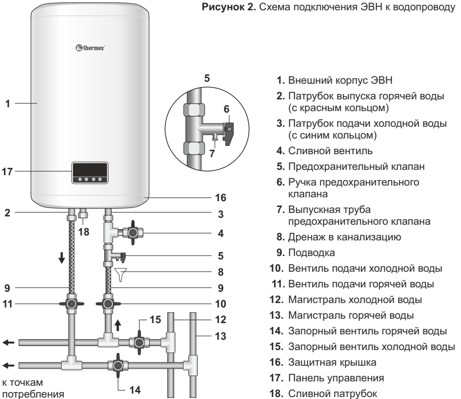
Рисунок 2. Схема подключения ЭВН к водопроводу
