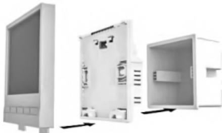
1. С помощью отвертки вытащите два штифта из-под нижней части корпуса и отделите верхнюю часть корпуса от нижней.
