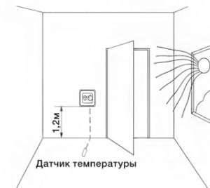
Терморегулятор имеет стандартные размеры (86 x 86 x 50мм) и устанавливается в стандартную распределительную коробку или подрозетник.
