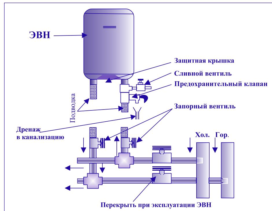
Рис. 2. Схема подключения ЭВН к водопроводу
