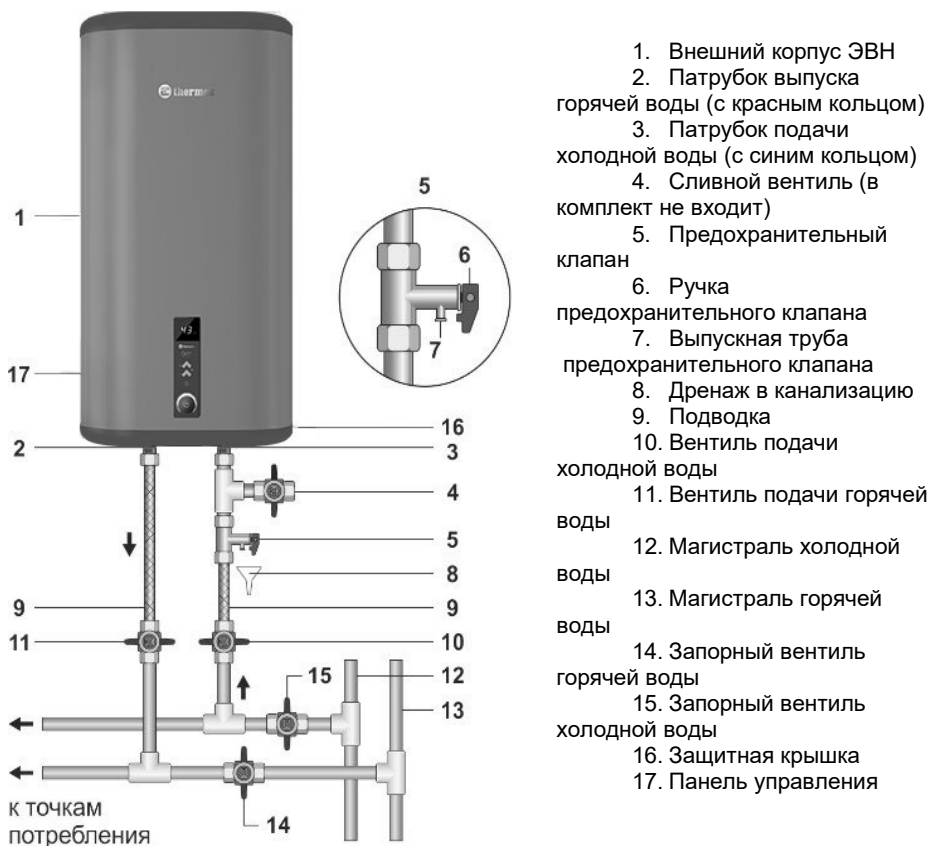
Рисунок 1. Схема подключения ЭВН к водопроводу.
